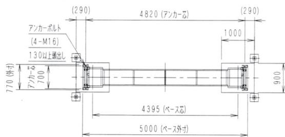
・基礎コンクリートは、設置場所の地耐力により検討する事。
